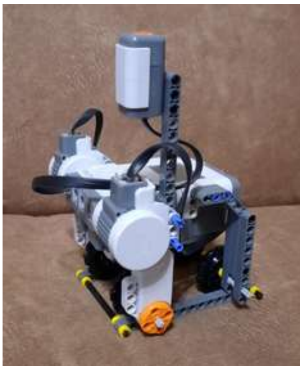
Рис.3.Макет устройства «Роботизированный осмотрщик вагонов – «ОКО». Ракурс 2.
