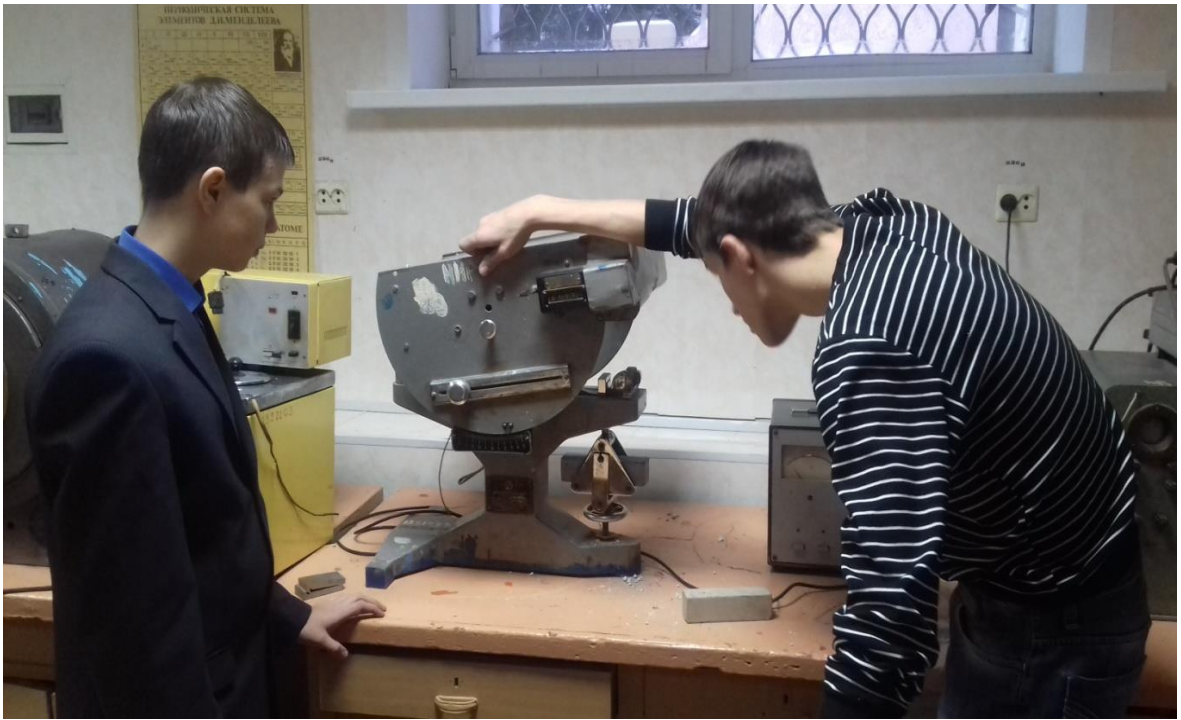
Фото 5. Определение прочности бетона при изгибе
