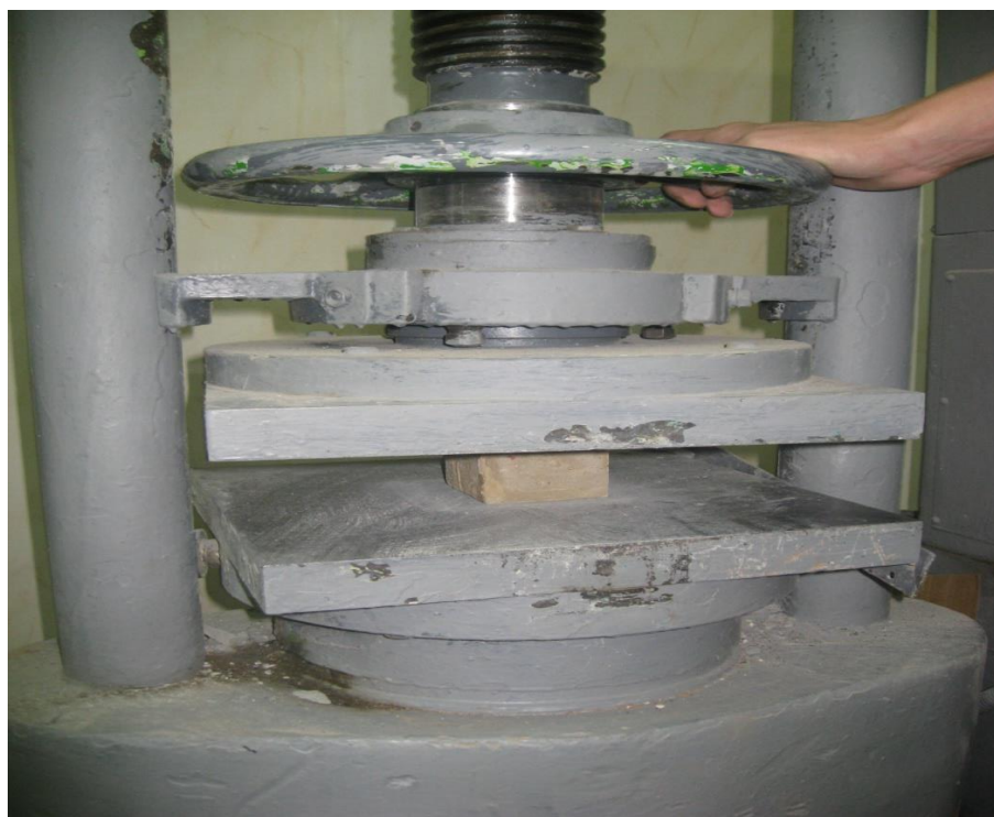
Фото 7. Вид образца, находящегося под давлением прессы.
