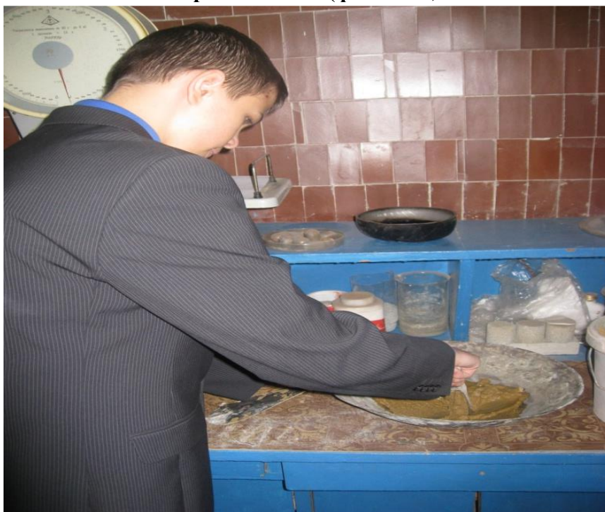
Фото 1. Приготовление бетонной смеси
