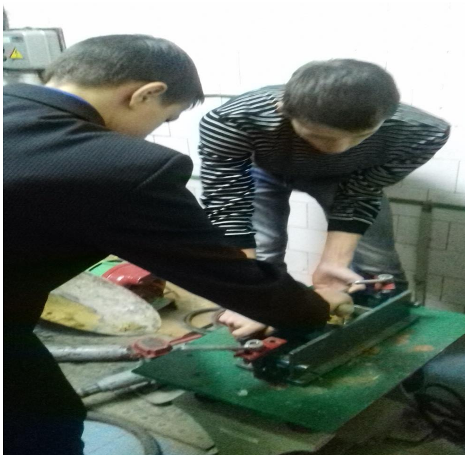
Фото 2. Формование образцов бетона смеси
