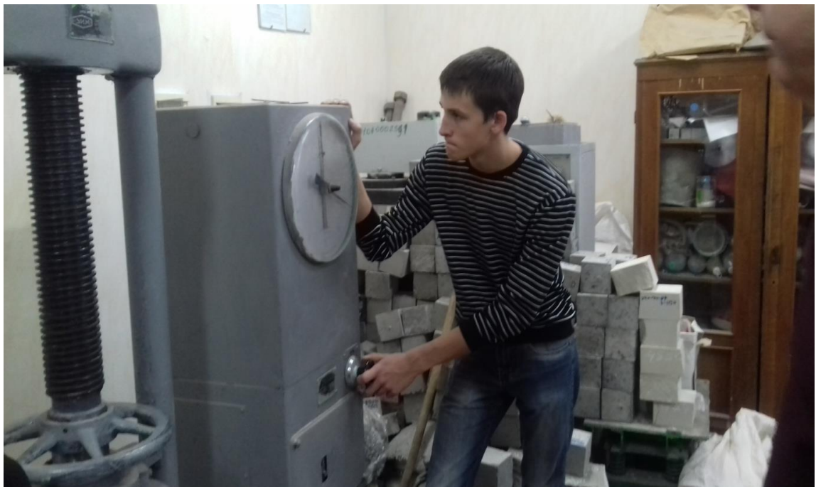
Фото 6. Определение прочности бетона при сжатии на пресс-установке
