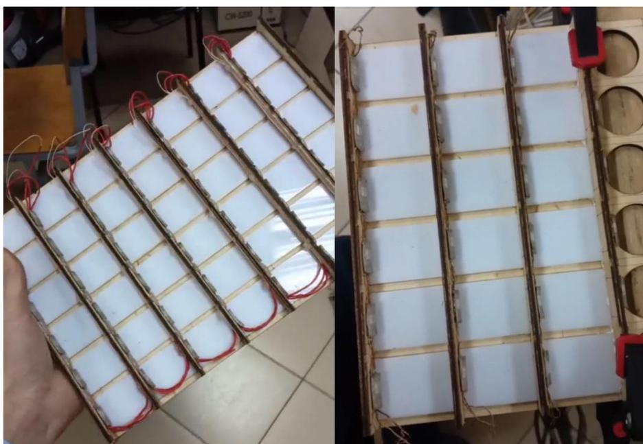
*Рис. 5, закрепление светодиодов и элементов оргстекла на панели*
