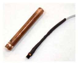
В основе корпуса датчик - медная трубка обжатая с одной стороны и облуженная. С другой стороны надеты несколько термоусадочных трубок на каждый провод в отдельности, общая на все провода и внутрь медной трубки, и общая на провод и медную трубку.
