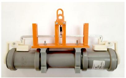
Батометр предназначен для отбора проб воды с заданной глубины водоемов . При погружении клапаны прибора находятся в открытом состоянии.
