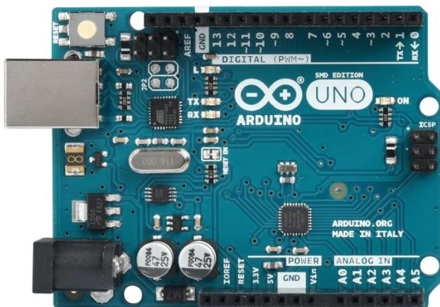
**ArduinoUNO** — аппаратная вычислительная платформа с микроконтроллером, основными компонентами которой являются микроконтроллер, устройство ввода-вывода и среда разработки. Arduino, применяется для создания электронных устройств с возможностью приема сигналов от различных цифровых и аналоговых датчиков, которые могут быть подключены к нему, и управления различными исполнительными устройствам
