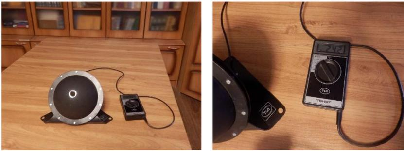
Рис. 8. Интегрирующая сфера – прибор для измерения светового потока.
