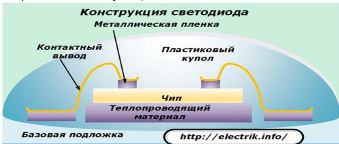
Рис. 3. Конструкция светодиода.
