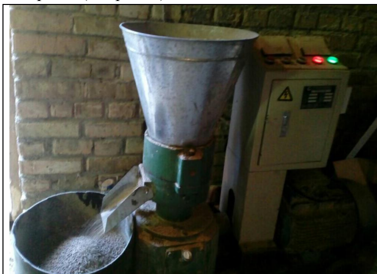
Рис. 4 –мини гранулятора матричного типа
