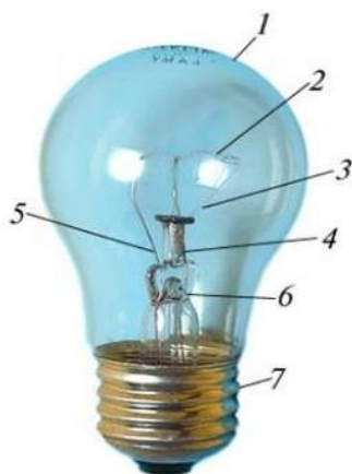
Рис. 2. Схема электрической лампы накаливания
